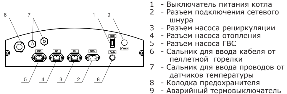
Рис.6 Расположение органов управления на задней панели пульта
