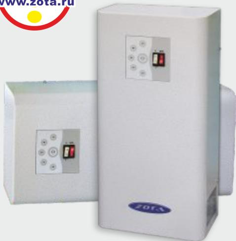
Проточный водонагреватель под коммерческим названием ZOTA "InLine" состоит из десяти моделей мощностью от 6 до 30 кВт и позволяет нагревать от 180 до 990 литров воды в час на 26 °С в зависимости от конкретной модели.
